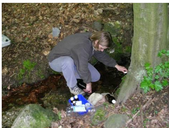
4-6. ábra: Merített mintavétel forrásból vízminőség vizsgálatához
